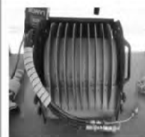
ชุด Oil, Skimmer แบบ Disk (ใช้กับน้ำมันดีเซล)
