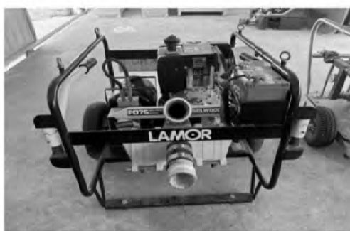
ชุด Oil, Skimmer แบบ Disk (ใช้กับน้ำมันดีเซล)
